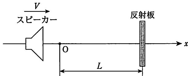
気温  $10^{\circ}\text{C}$  の無風状態において、スピーカーが原点 O を通過する際に、 $55\text{ kHz}$  の超音波を出し始めた。すると、 $0.20$  秒後にスピーカーの位置にいる観測者に反射音が到達し、振動数  $2.5\text{ kHz}$  のうなりが観測され始めた。これより、スピーカーが O を通過してから反射板と衝突するまでにかかる時間が、 $10^{\circ}\text{C}$  での音速を  $340\text{ m/s}$  として、有効数字 2 桁で (5) 秒と評価できる。気温が  $10^{\circ}\text{C}$  より高い状態で振動数  $2.5\text{ kHz}$  のうなりが生じた場合、衝突までにかかる時間は、 $10^{\circ}\text{C}$  のとき (あ)。
